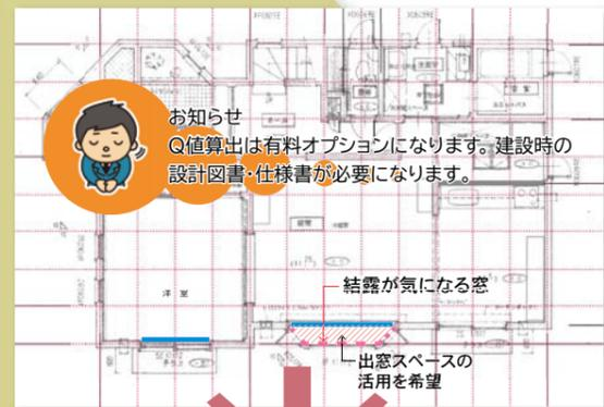
洋室の内窓の取り付けと、リビングにある大きな出窓のガラス交換、そして内窓の取り付けです。
