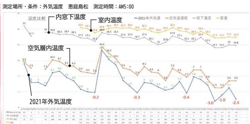
まだ外気温度が厳寒期の様に-10℃を下回る様な気温になっていませんが、やっと冬らしい外気温度になって来ました。この状況で空気層内温度と内窓下温度の差が10℃程あります。窓の表面温度が室温に近い事から、以前の様なコールドドラフト、また結露の発生抑制に効果がある事が判ります(下記窓下温度と室内温度をご覧ください)。窓からの冷気を感じ、足元がすうすうするなどのご不満をお持ちの方は、一度内窓の設置のご検討をお勧めいたします。
